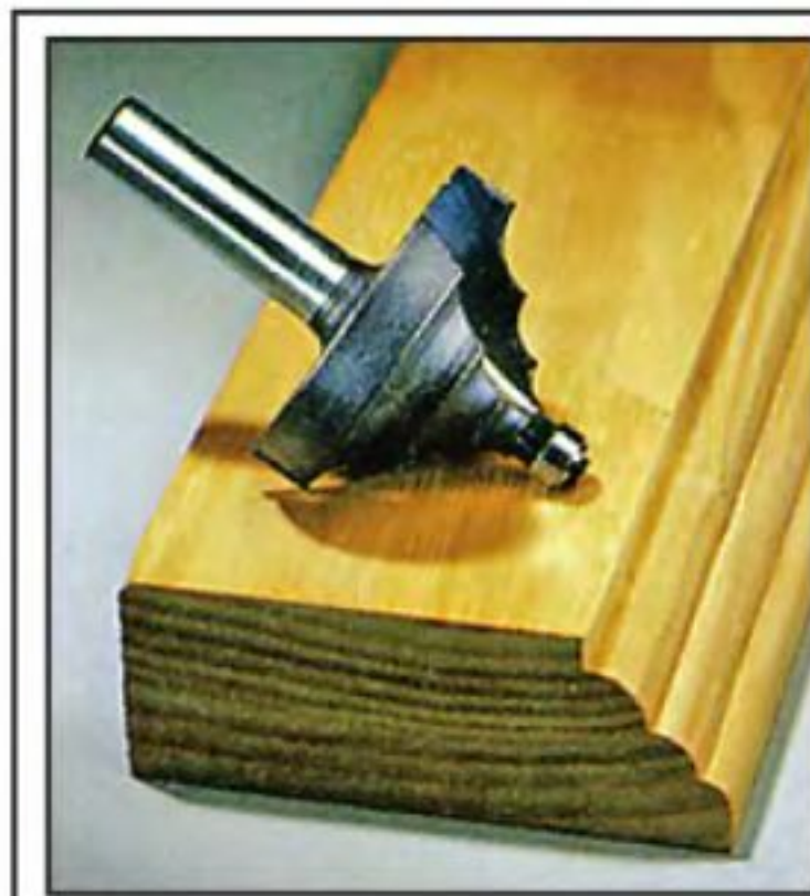
Снизу этой трёхрадиусной фрезы (Ø3, Ø5 и Ø7 мм) — направляющая цапфа.
