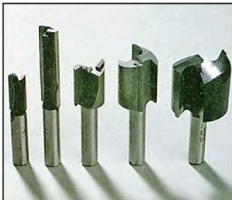
Различают цилиндрические пазовые фрезы с боковым и торцовым направлением резания. Рабочая длина фрез — от 6 до 40 мм.
