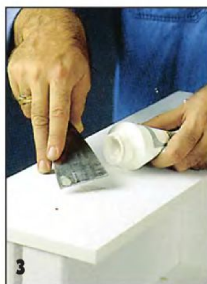
3 Обнаруженные дефекты на лицевых поверхностях деталей комода устраняют шпатлеванием.
