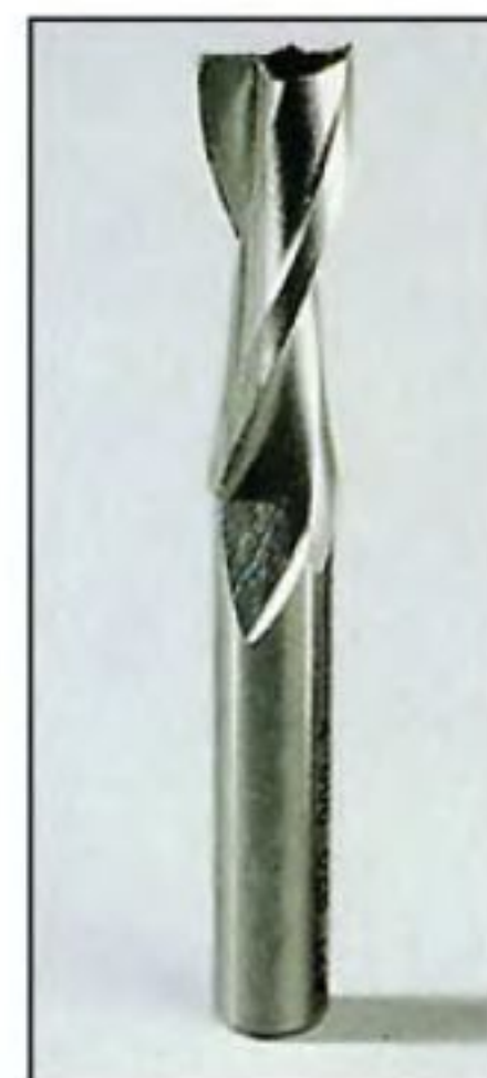
Спиральная пазовая фреза очень напоминает спиральное сверло. В сравнении с обычными пазовыми фрезами с прямыми ножами она работает с меньшей вибрацией, а потому — менее шумно.
