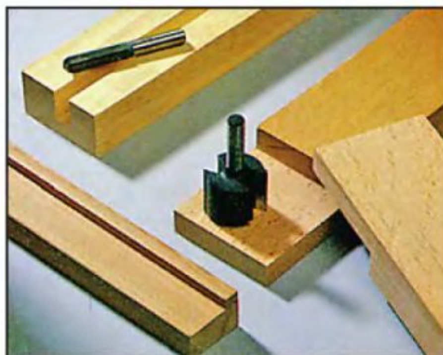
Цилиндрические пазовые фрезы применяют для сверления глухих отверстий, выборки пазов, прорезей, четвертей (фальцев) и уступов под соединение врубкой вполдерева. На такие фрезы не ставят упорных направляющих подшипников.
