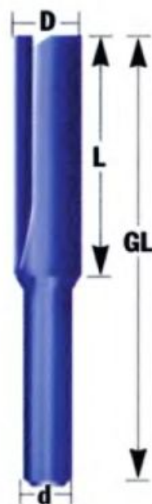
Основные параметры пазовой фрезы: d — диаметр хвостовика; D — рабочий диаметр; L — полезная рабочая длина ножей; GL — общая длина фрезы.
