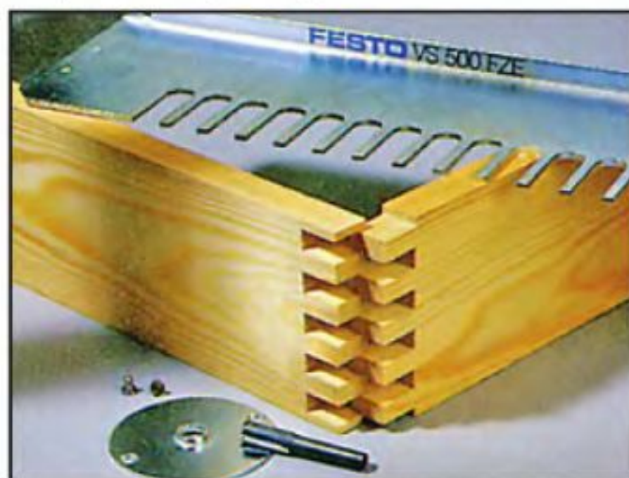
Прямые шипы, нарезанные с помощью пазовой фрезы Ø10 мм. Для этого в качестве направляющей инструмента используют специальное шипорезное приспособление, позволяющее точно определить расстояние между шипами.
