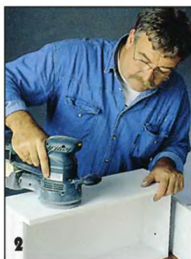
2 Независимо от вида отделки и облицовки изделия все поверхности, подлежащие декорированию, готовят под окраску. Для этого сначала их обрабатывают шлифовальной шкуркой зернистостью 100 с помощью электроинструментов или вручную.
